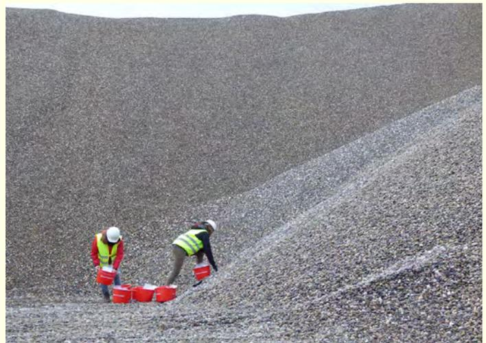
Abb. 5: Beprobung des Haufwerks einer Kiesgrube.
