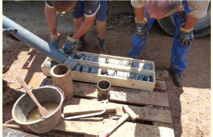
Abb. 4: Einbringen des Bohrkerns aus dem Kernrohr in Kernkisten.
